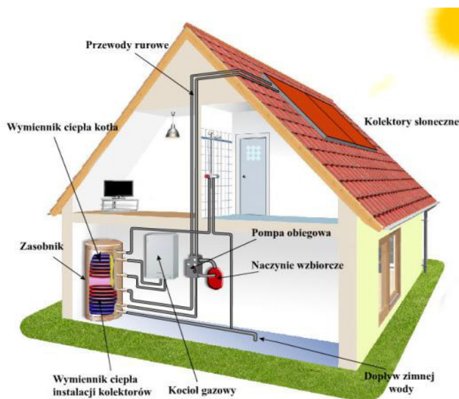
Ryc. 7. Schemat instalacji kolektorów słonecznych w domu jednorodzinnym
