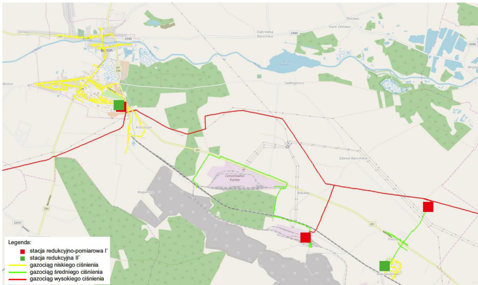
Rysunek 1. Schemat sieci gazowej na terenie Gminy Barcin
