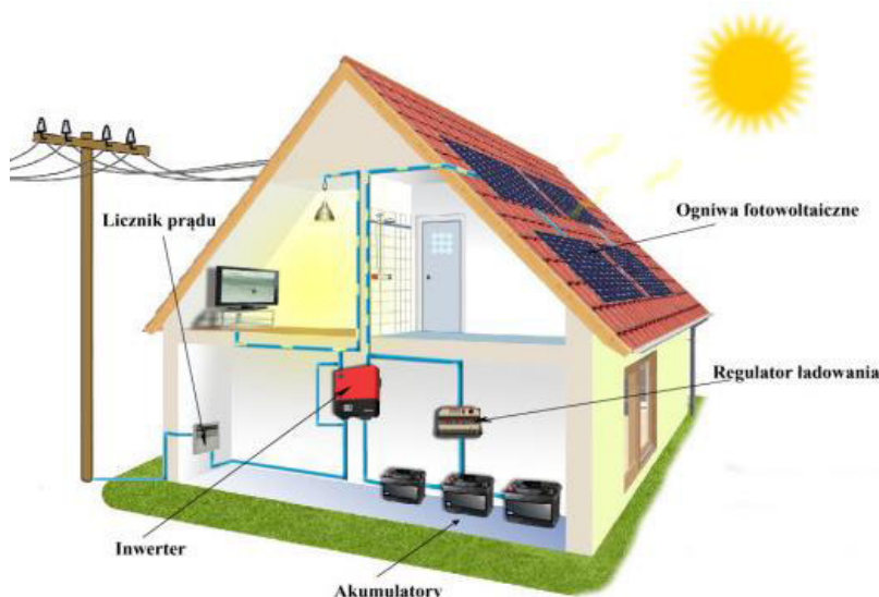
Ryc. 8. Schemat instalacji fotowoltaicznej w domu jednorodzinnym
